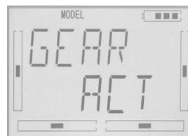
In diesem Menüpunkt können sie den Kanälen „GEAR“ und dem „AUX2“ bestimmte Schalter zuweisen, aktivieren (ACT) / deaktivieren (INH). Gehen sie ins Modellmenü und wählen sie mit „UP / DN“ den Menüpunkt „OUTPU“, drücken sie „ENT“ und sie können mit „UP / DN“ entsprechend die Funktionen GEAR/AUX2 wählen
